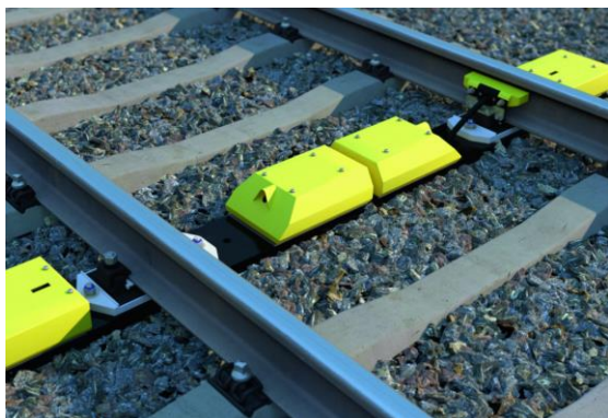
Obraz 9: Przykładowe zastosowanie detektorów podczerwieni w systemie kontroli temperatury kół kolei dużych prędkości Obraz 10: Przykładowe zastosowanie detektorów średniej podczerwieni w inteligentnej amunicji
